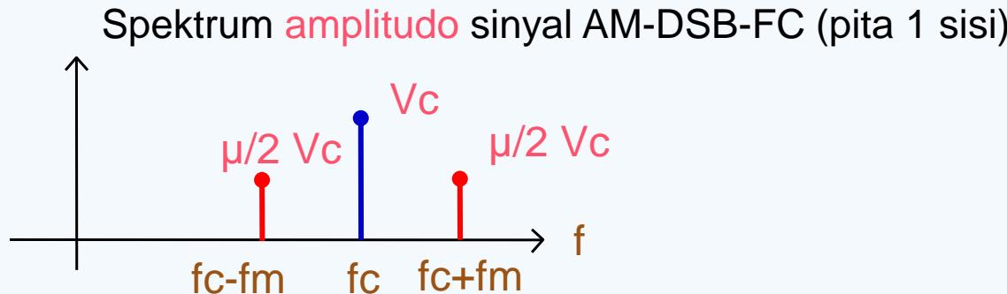
Perbandingan daya komponen carrier, komponen Upper sideband dan komponen Lower sideband
